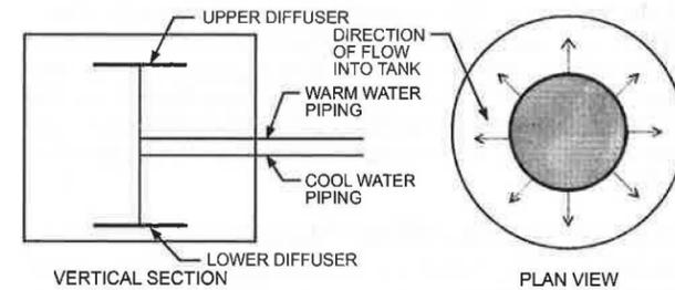
Fig. 4 Radial Disk Diffuser
